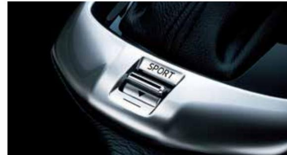
El interruptor de Drive Selection\* en la placa guía de los cambios permite pasar al modo Deportivo, ajustando automáticamente las características del motor y la transmisión para una potente aceleración y respuesta lineal cuando se entra en una autopista con mucho tráfico.
