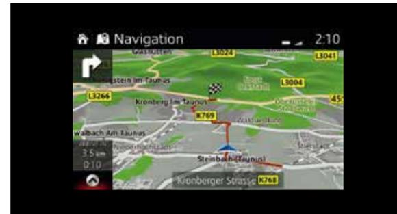
Los datos del sistema de navegación se ofrecen en una tarjeta SD opcional, permitiendo visualizar su posición actual en un mapa o rutas sugeridas en la pantalla central. Si el dato de navegación incluye límites de velocidad, la nueva función de advertencia de límite de velocidad los visualiza en la Active Driving Display.
